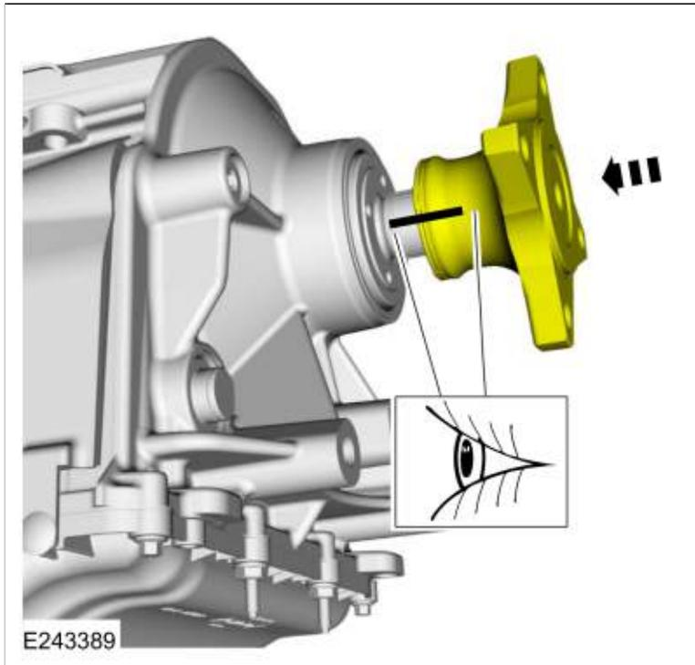
4. Install the new output shaft flange bolt.
