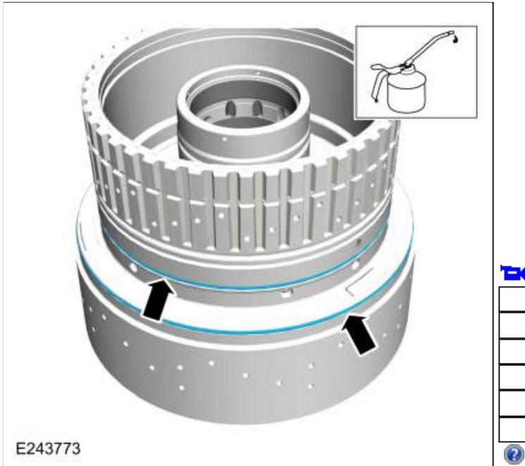
126. Install the F clutch piston.
