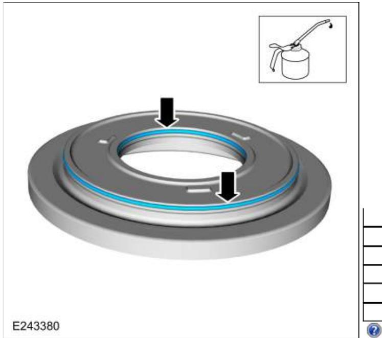
148. Install the C clutch piston.
